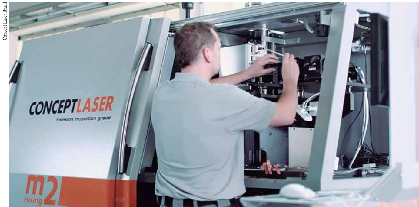
Máquina de impressão em 3D por fusão seletiva a laser, utilizada no projeto que deve melhorar qualidade de vida a pessoas com deficiência.
