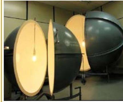
**Esfera integradora para medição do fluxo luminoso de lâmpadas**
